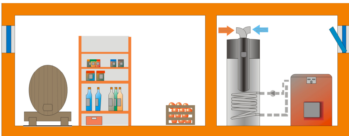
Bild 2: Ansaugen aus dem Raum - Ausblasen in den selben oder einen entfernten Raum
